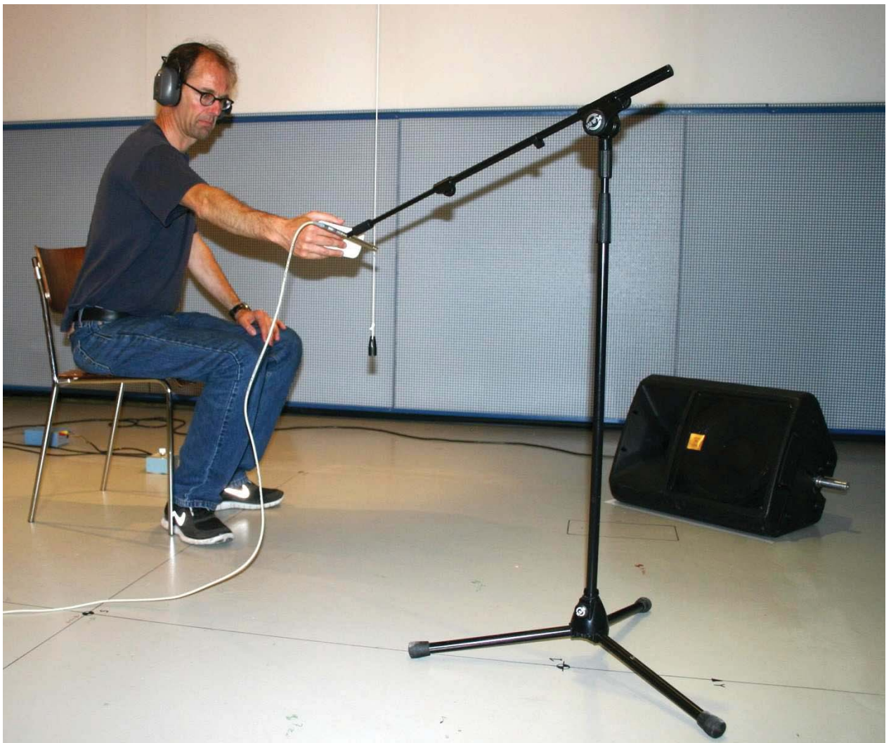
Abbildung 1: Messkonfiguration im reflexionsarmen Raum mit hartem Boden.
