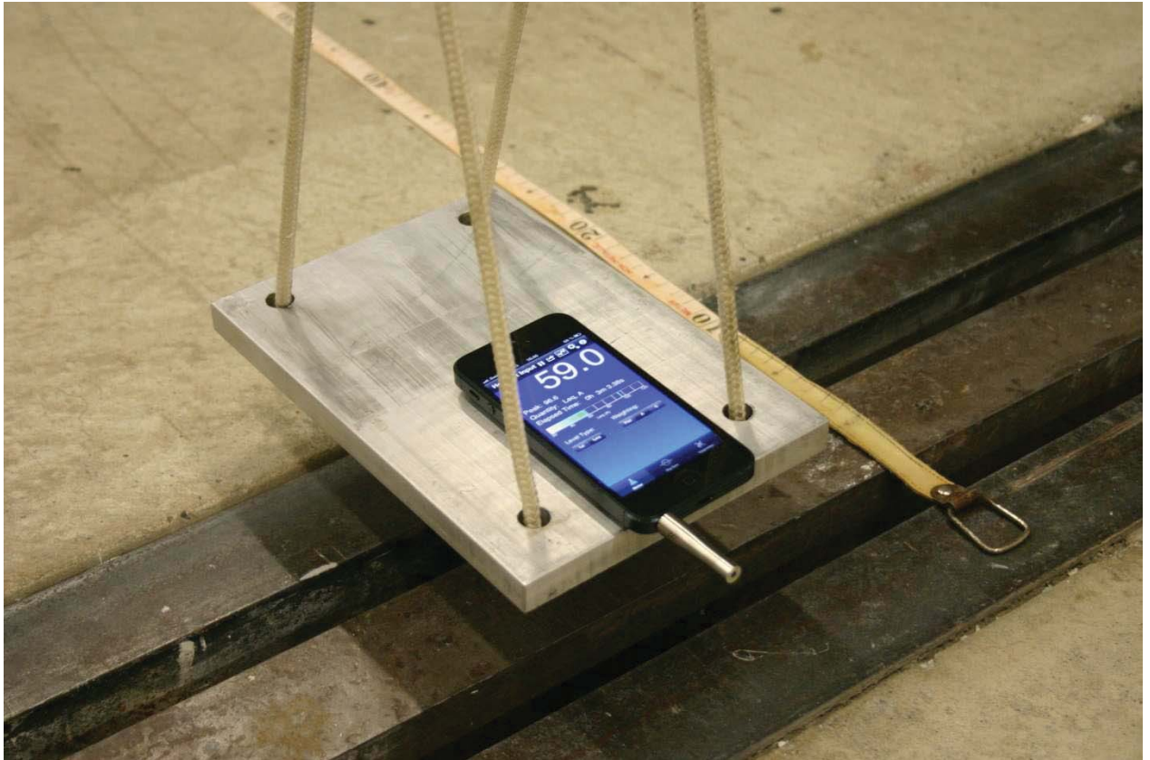
Abbildung 4: Pendelplatte in Ruhelage mit installiertem Smartphone und externem Mikrofon ohne Windschirm.
